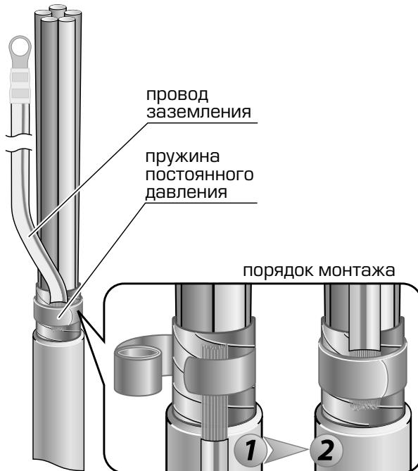
**Выполняется только для кабелей с броней (экраном заземления)**
